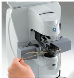
È possibile misurare la distanza interpupillare (DI) facilmente. Il modello LM-1800PD offre il rilevamento automatico Destro / Sinistro con l'apposita guida scorrevole che consente anche di trattenere gli occhiali durante la misurazione.
